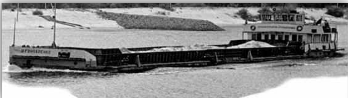
Рисунок . 11. Суховантажний річковий теплохід-площадка типу «СТ» проекту № 414.
