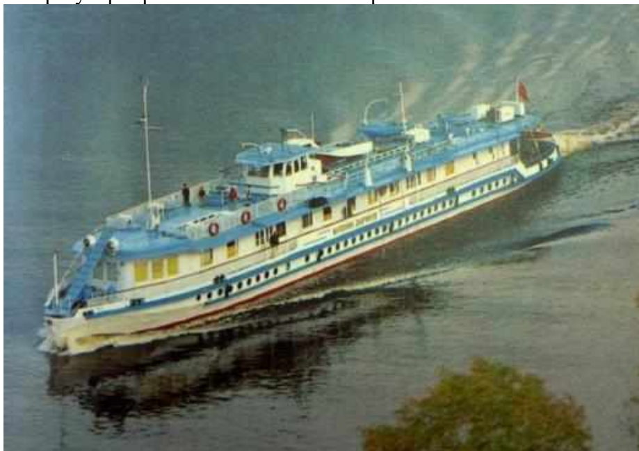
Рисунок 14. Пасажирський теплохід для малих річок проєкту № 331.
