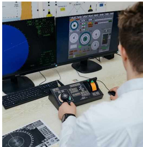
Рисунок 1 – Навігаційний тренажер Transas NT – 5000 Pro, ОНМУ
