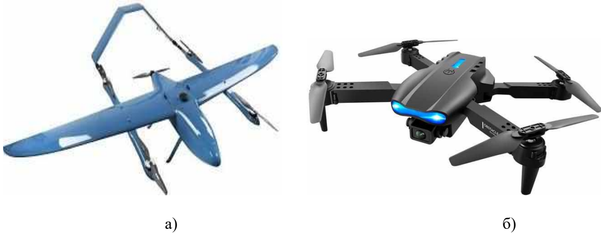
Рисунок 2 – Різні типи безпілотних літальних апаратів: а) літакового типу з нерухомим крилом; б) багатороторний
