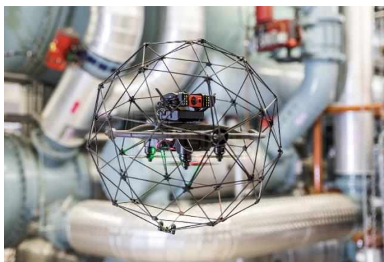
Рисунок 4 – Універсальний БПЛА Elios 3 для проведення дистанційних планових перевірок в умовах обмеженого простору (Джерело – За матеріалами [25])
