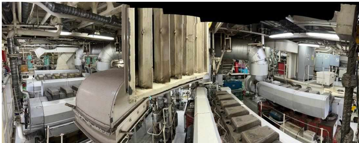
Рисунок 1 – Розміщення суднових дизелів Wartsila 6L32F в машинному відділенні
