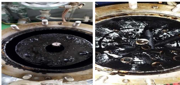
Рисунок 4 – Автоматичний фільтр після 2 годин роботи при високому рівні алюмосилікатів в паливі (Джерело: фотографії з судового архіву).
