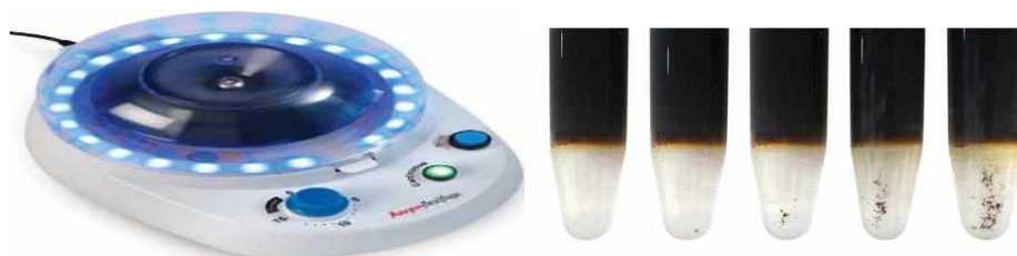
Рисунок 1 – Центрифуга та мікроцентрифужні пробірки з різним вмістом алюмосилікатів з тест-набору Cat Fines Check [36]
