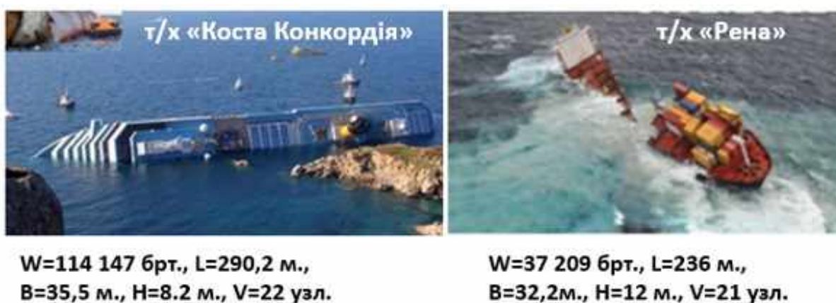
Рисунок 1 - Наслідки зіткнення з підводними рифами теплоходів «Коста Конкордія» і «Рена»
