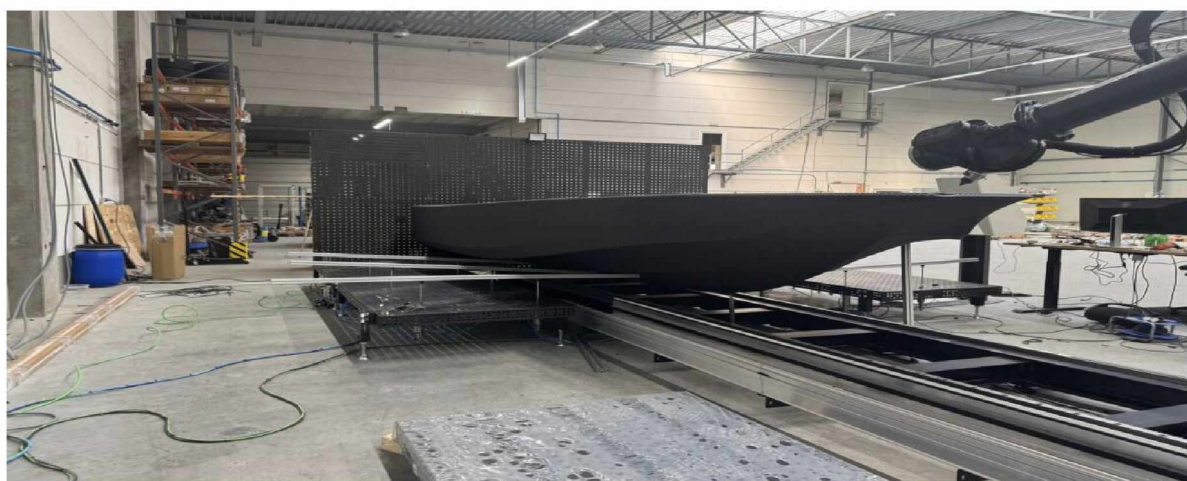
Рисунок.8 – 3D-друк цілих корпусів суден з HDPE (джерело : [28])
